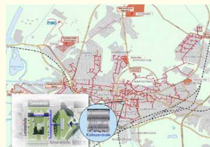
Abbildung 22: Kälteerzeugung aus Fernwärme verbessert die Netzauslastung im Sommer (Karlsruhe)
